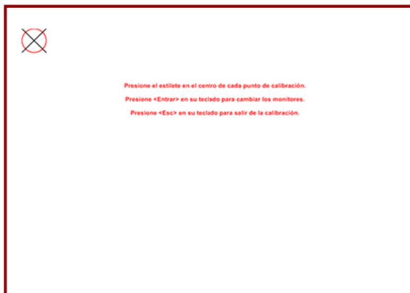
Para calibrar solamente tienes que presionar con el puntero sobre cada uno de los puntos de calibración, procurando tener el puntero lo más perpendicular posible sobre la superficie de escritura.
